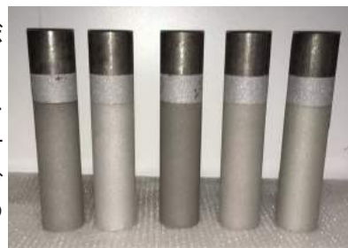
ポイラチューブの耐久性向上させる溶射コーティング
